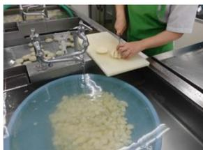
ピーラーは、大量のジャがいもの皮を剥くのに使います。器の中がザラザラになっていてホースで水を流しながら中がくるくると回ってジャガイモの皮が剥けます。その後は、手作業で一つ一つ包丁で芽取りをし、一口で食べられる大きさにカットします。
